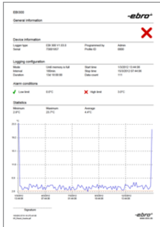
Digitale Temperaturüberwachung aller Kühleinrichtungen per Datenlogger
