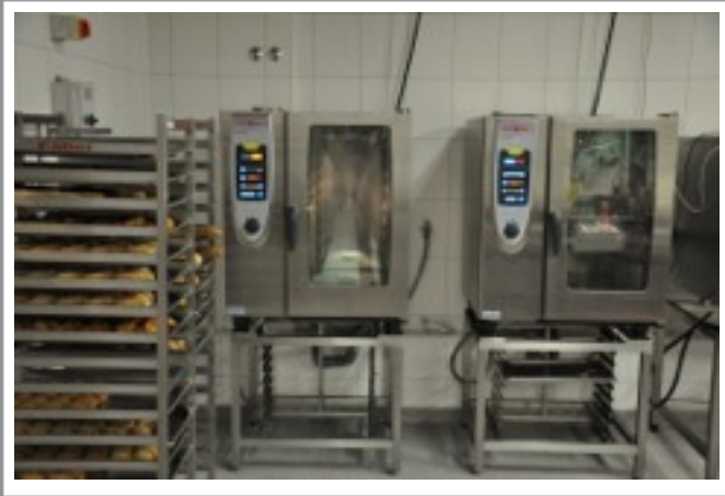
Modernste Küchentechnik: hier Rational SFC101 mit Auswertung der Garprozesse per USB-Stick
