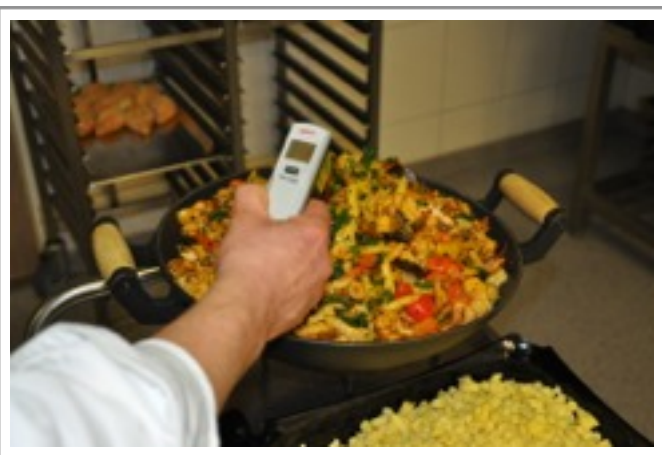
Stichprobenartige Temperaturkontrollen mit Infrarottechnik der Fa. Elro
