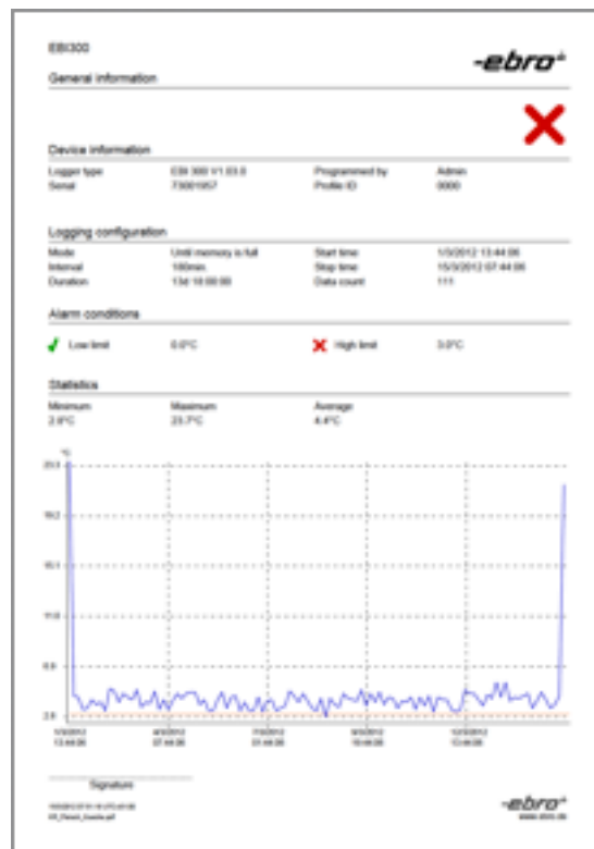
Digitale Temperaturüberwachung aller Kühleinrichtungen per Datenlogger
